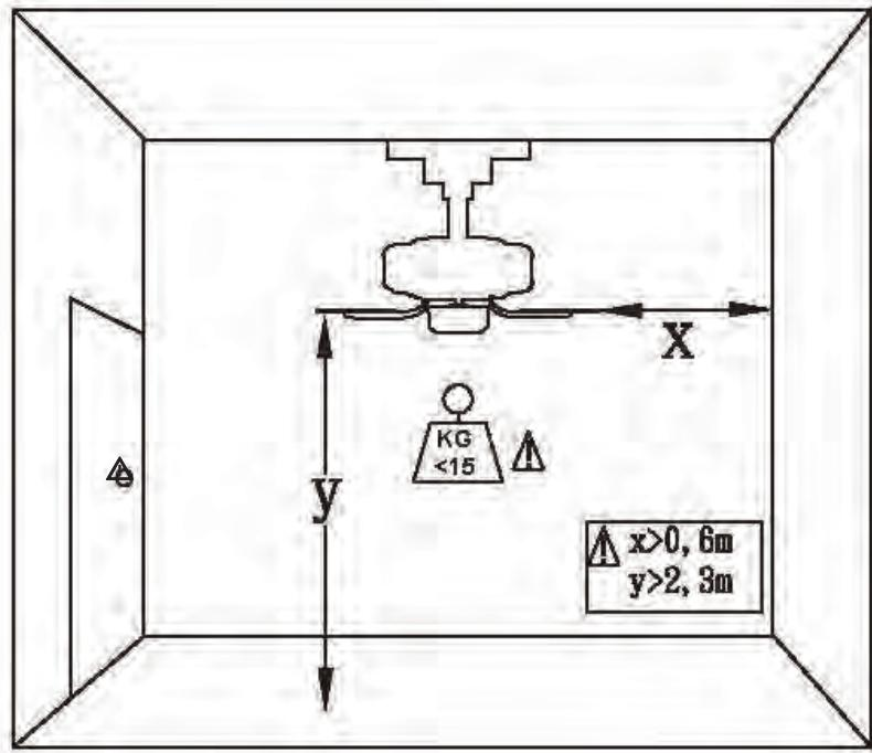
Расстояние между лопастями вентилятора и стеной должно быть не менее 0,6 м.
