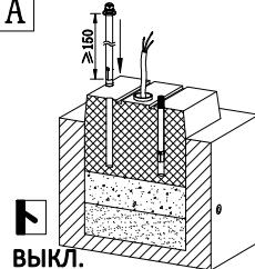
▲ Глубина котлована должна быть определена путем выемки грунта до исходного состояния. В случае обратной засыпки углубленный короб может быть установлен только после закачки воды и оседания бетона.
